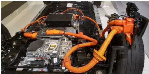
Elektrisk installation i elbil 400-900 Volt DC
