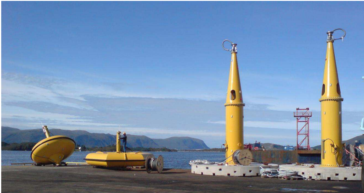
Figur 22 Seabased, Sweden, 2 stk. 25 kW moduler til et 10,5 MW bølgekraftværk ved Lysekil [ W37 ].
