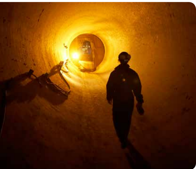
Indkig i en cement-rotérovn under et hovedstop
